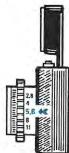
Fig. 9 Ammesso che la pellicola fosse una 100 ASA, dovremo regolare il diaframma su f/5,6, se fosse invece una 400 ASA, con lo stesso diodo led acceso, dovremo regolare il diaframma su f/11.
